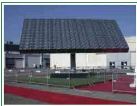
Figura 21: Sistema fotovoltaico ad alta concentrazione
