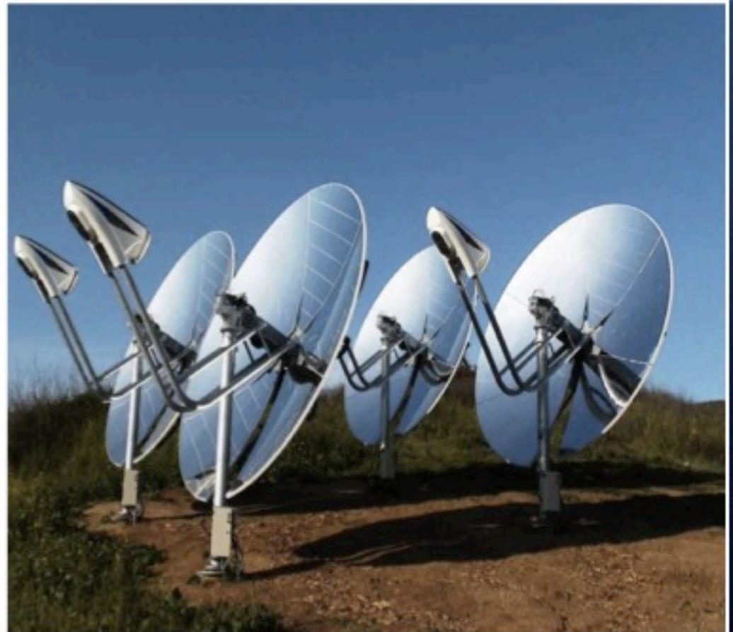
Dotato di motore Stirling monocilindrico a pistone libero
