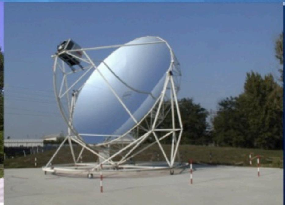
Il generatore, con un paraboloide del diametro di 8,5 m., è incorporato in una struttura che consente la rotazione su due assi. Il motore Stirling SOLO 161, potenza nominale di 10 kW, è installato al vertice, con lo scambiatore caldo sul piano focale del concentratore.
